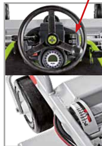
Regulación altura de corte continua e hidráulica
