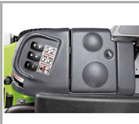
Comandos con interruptores eléctricos
